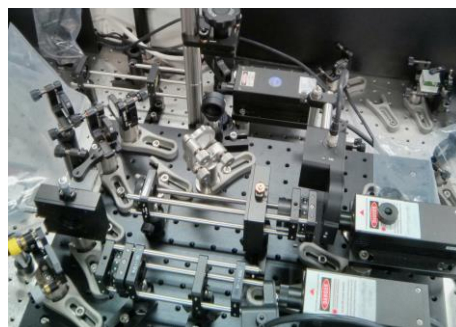
図 1. ブレッドボード上に構築した超解像光学顕微鏡の光学システム
